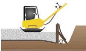
**veriso Schaumglas verdichten:** Für die Verdichtung empfehlen wir vorwärtslaufende, leichte Rüttelplatten mit leichtem Vortrieb. Das Verdichtungsverhältnis 1,3:1 erreicht man z.B. mit Rüttelplatten ~ 100-120 kg, Frequenz: 80-100 Hz und einer Arbeitsbreite  $\geq$  500 mm.
